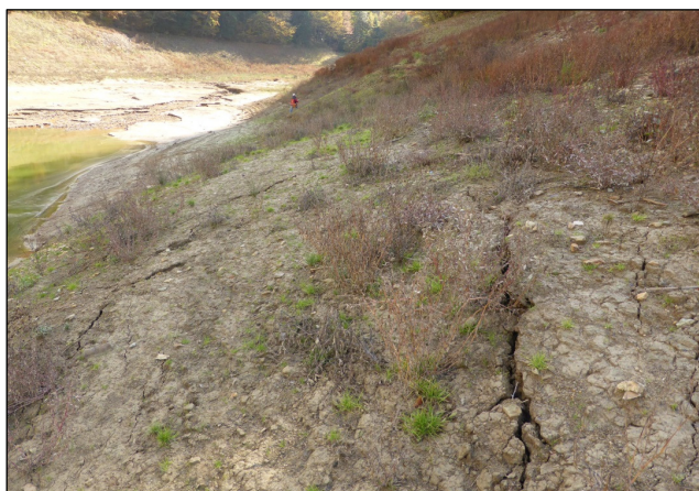
Obr. 29. Trhliny v akumulačnej oblasti zosuvu (na povrchu bada- telné obnažené úlomky andezitov; foto J. Šimeková).
